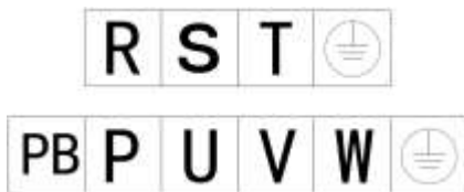
图 3-4 4kW-5.5kW（2020 型）主回路接线端子
